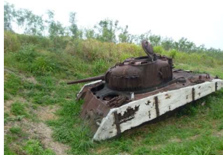
戦車の側面はコンクリートで硫黄の腐食を防ぐ対策で戦っていた
